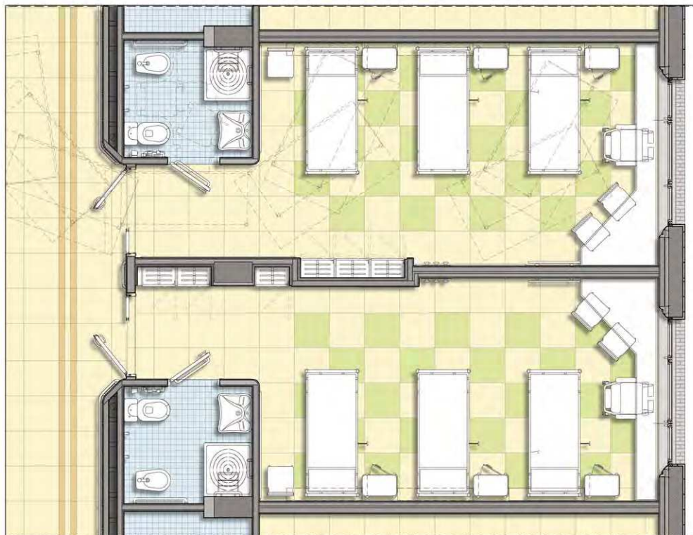
Particolare delle camere di degenza tipo
